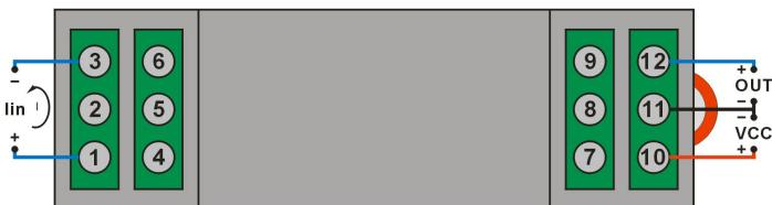
注: 1、3 位端子为输入端子；11、12 位端子为输出端子；10、11 端子为电源端子。
