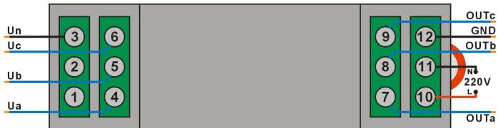
注: 3、4、5、6 位端子为输入端子; 7、8、9、12 位端子为输出端子; 10、11 位端子为电源端子。输出地与电源地不共地; 1、2 位端子为空脚。
